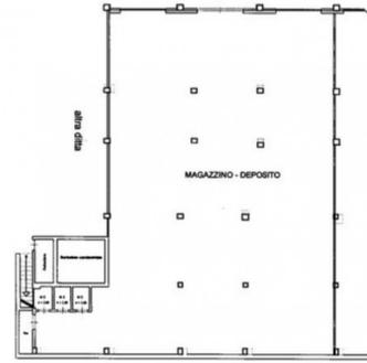
Pianta Piano Primo sottostrada H= mt. 3.60
